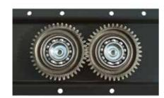
In aggiunta, il gruppo di taglio è dotato di un sistema di sicurezza integrato, progettato per intervenire in caso di impatti violenti con ostacoli. La scanalatura esterna consente al supporto del disco di spezzarsi in maniera controllata, preservando gli altri ingranaggi della barra di taglio.
