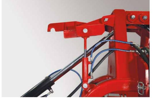
Durante l'operazione di taglio, il gancio di sicurezza va abbassato, fungendo da blocco per il cilindro e limitando l'altezza della falciatrice a un massimo di 35°, proteggendo così gli alberi cardanici e garantendo un funzionamento ottimale.
