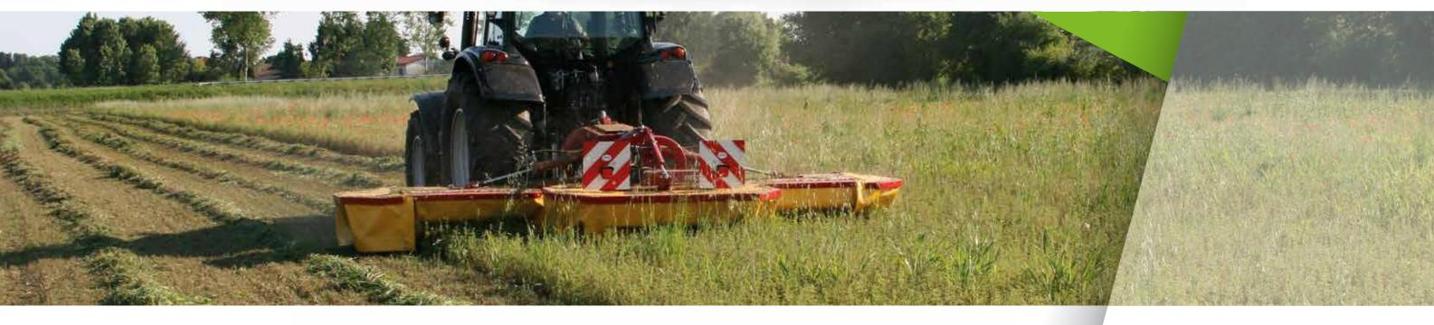
Le falciatrici combinate COMBI-T500, COMBI-T500GM, COMBI-T600 e COMBI-T600GM sono progettate per ottimizzare il processo di falciatura. Queste macchine sono composte da tre elementi falcianti a 2 tamburi ciascuno: uno frontale e due laterali, tutti montati anteriormente, da applicare ad un trattore con presa di forza frontale.
