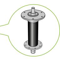
Il rotore è progettato in modo tale da preservare tutti i componenti interni da eventuali urti e impurità e la forma aerodinamica dei cilindri aiutano a creare un'andana uniforme tra i tamburi. L'intera struttura del tamburo viene avvitata per consentire un rapido smontaggio.
